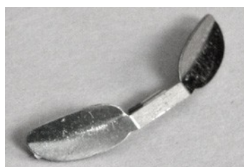
Plogbladen kupade och lätt vinklade bakåt.
