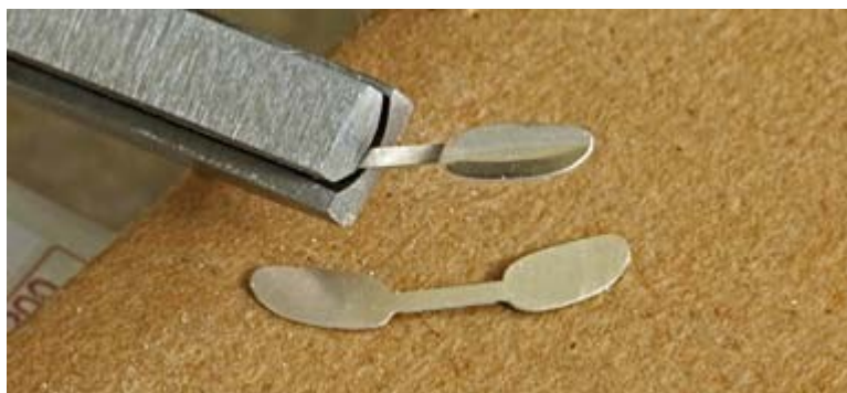
Kupning av plogblad med specialtången
